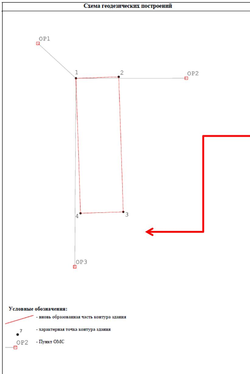
Раздел "Схема геодезических построений" оформляется в соответствии с материалами измерений, содержащими сведения о геодезическом обосновании кадастровых работ (пункт 53 Требований).
